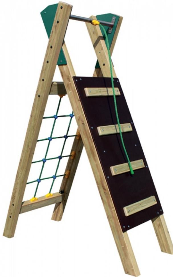
Jeu pour enfants de plus de 3 ans conforme à la norme EN 1176 et EN 16630. Un jeu d'escalade à double pente avec une pente à grimper avec corde et un filet à grimper. Composition des différents éléments : bois et bois stratifié traité en autoclave classe IV, panneau de coffrage, HPL, inox, corde en polyester : 199 cm. Surface d'implantation : 5,75 x 4,64 m. Surface de sécurité : 24,4 m<sup>2</sup>.
