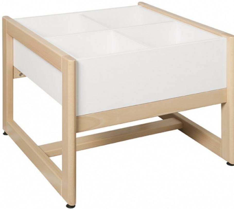
Piètement de la gamme de mobilier de bibliothèque Mars. Piètement en hêtre massif de section 60 X 28 mm. Cadre du piètement composé de 2 montants profilés et de 2 traverses assemblées par tourillons de guidage et colle. Assemblage mécanique des traverses de liaison sur les cadres par goujons et boîtiers excentriques. 4 cases L 62 X P 62 cm. Hauteur enfants H 51 cm. Capacité : 100 albums.
