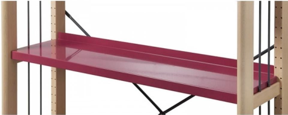
Tablettes droites en tôle 10/10ème. Finition peinture époxy. Dossieret de 30 mm et retombée sur l'avant de 30 mm. La charge admissible est de 70 kg. Tablette droite P 25 cm livrée avec une paire de supports chromés.
