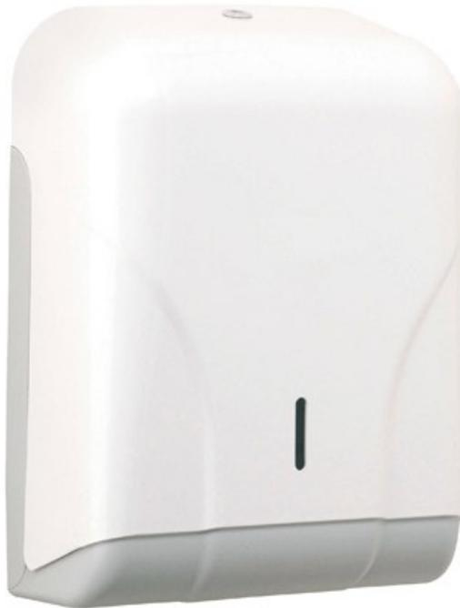
Distributeur d'essuie-mains en ABS. Façade blanche et base grise. Repère de consommation. Capacité : jusqu'à 400 feuilles de papier essuie-mains enchevêtrées 24 x 26 cm. Verrouillage par serrure à clé plastique. Ouverture frontale facilitant la mise en place du consommable et le nettoyage. Fixation murale 4 points. Dims (cm) : L 28 X P 13 X H 37. Poids : 1,05 kg.
