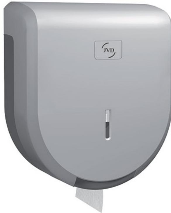
Capacités : rouleaux de 200 m. Mandrin diamètre 45 mm. Découpe facile. Capot et châssis ABS gris métal. Fermeture sécurisée avec clé. Visualisation du niveau du consommable. Changement très facile des consommables. 4 points de fixation (kit de montage inclus). Dims (cm) : L 24,5 X H 27,5 X 12.
