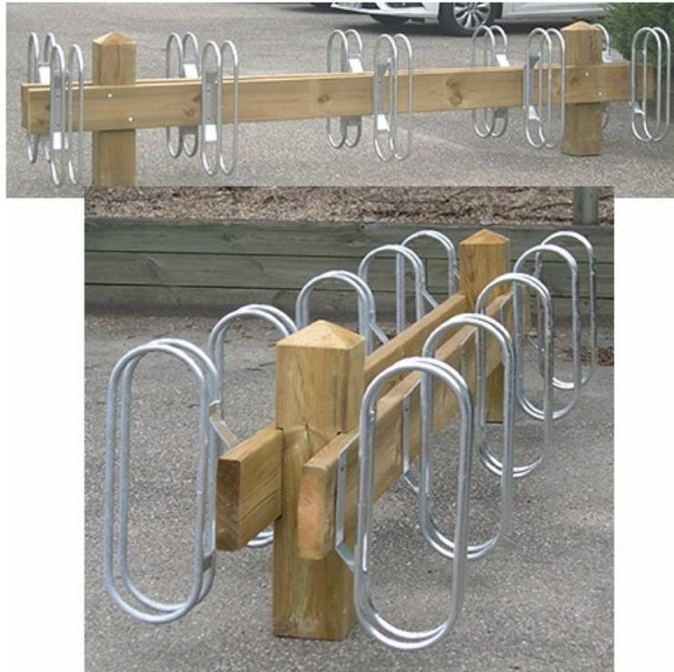
Range vélos 10 places en face à face, bois et acier, esthétique et robuste. Poutres principales en pin section 17 x 4,5 cm. Piétement en pin section 14 x 14 cm. Pointe de diamant en tête de poteau. Bois raboté. Traité classe 4. Certifié PEFC et CTB B+. Supports vélos en acier galvanisé à chaud. Fixation au sol par scellement béton. Fabrication française. Dims (cm) : L 280 X P43 X H 60. Poids : 60 kg.
