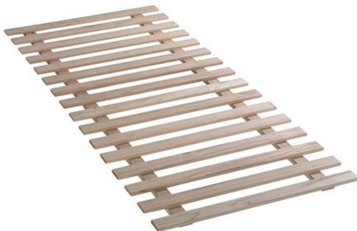
Pour lits gamme Mistral. Structure en hêtre massif. Lattes collées et agrafées sur les traverses. Toutes les arêtes sont chanfreinées. Traverses : 60 x 22 mm. Lattes : 60 x 16 mm. Conforme aux normes NF EN 13453-1 et 13453-2\* Produit optionnel, vendu uniquement avec le produit auquel il s'associe.
