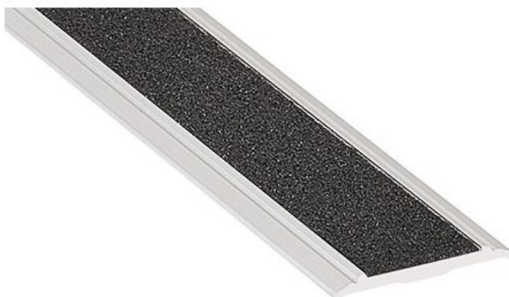
Indispensable pour l'accessibilité des PMR. Le nez de marche plat en aluminium est antidérapant et réduit les risques de glissades grâce à son contraste visuel. Anti-dérapant auto-collant livré à part. A visser avec rail pré-percé. Pour un usage intérieur ou extérieur. Dims (cm) : L300 x P4,1. Bande antidérapante P3 cm.
