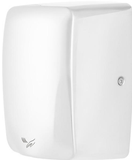
Sèche-mains anti-vandalisme. Capot en acier inoxydable AISI 304. Finition peinture poudre époxy blanc. Séchage rapide. Temps de séchage : 10 à 15 secondes. Vitesse d'air en sortie : 215 à 380 km/h. Débit sonore limité : 65 à 72 dB. Moteur monobloc à balais. Chauffage auto-régulé < 40°C. Consommation électrique 500 à 1150 W. Tension d'alimentation 220-240V. Protection électrique : IPx1 Classe I. Aucun entretien nécessaire. Dims (cm) : L18 x P15,2 x H26. Poids : 3 kg.
