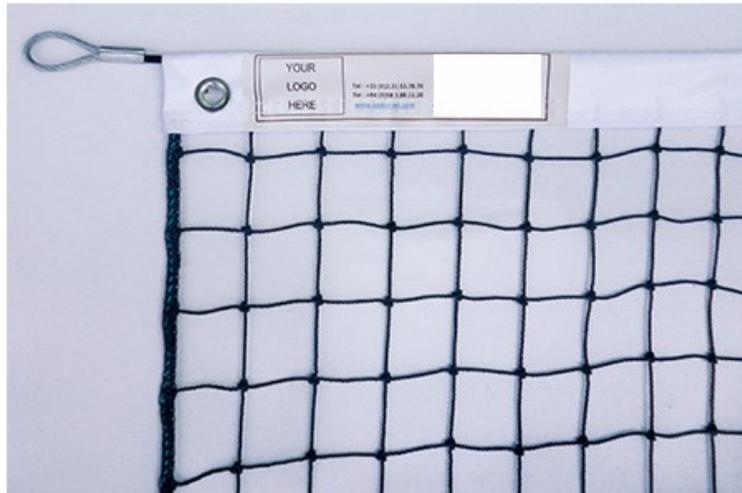
Filet de tennis sans régulateur. Fabriqué en polyéthylène 2 mm haute densité traité UV. Maille simple. Bande haute en PVC. Câble en acier galvanisé gainé 5 mm. Dims (m) : 12,70 x 1,07.
