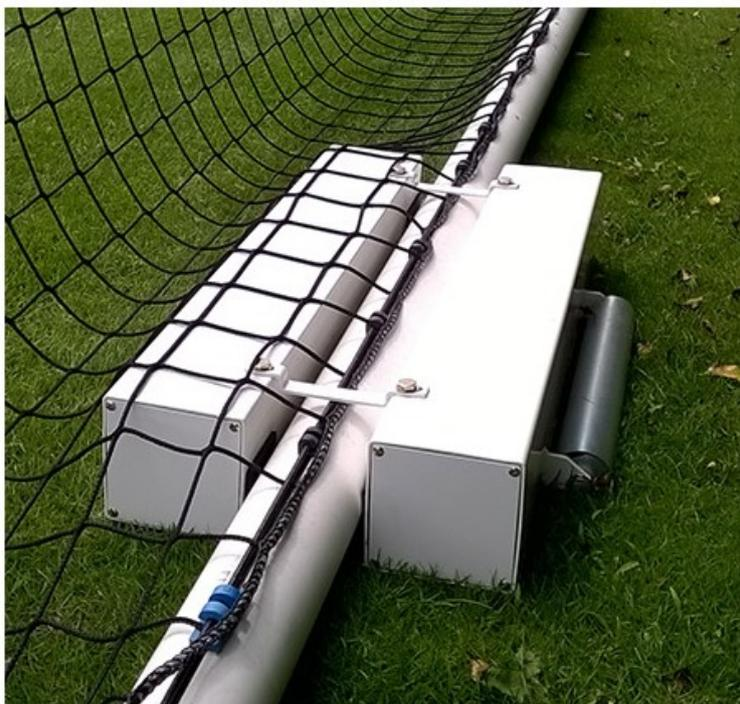
Contrepoids à lester avec du sable (non fourni). Le contrepoids est à fixer à la barre arrière basse avec une pièce d'adaptation supplémentaire qui s'adapte au profil de la barre en fonction de sa dimension (en option nous contacter). Les rouleaux intégrés facilitent le déplacement du but. Jeu de 2 contrepoids par but. Contrepoids en tube d'acier électrozingué de section 140x140x3 mm, finition plastifié blanc. Rouleau en tube d'acier diamètre 60x1,9 mm. Dims (cm) : L80 x P40.
