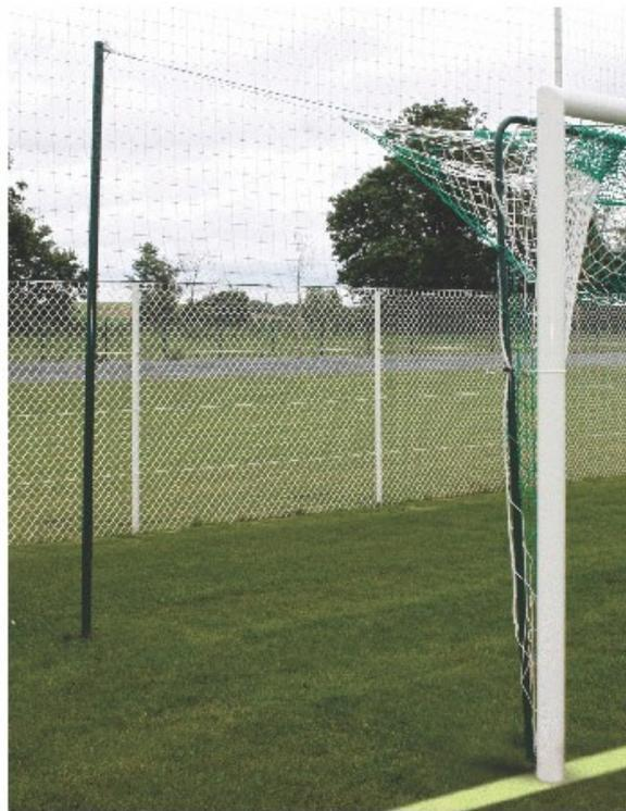
Jeu de 4 mâts arrière en tube galvanisé Ø49x2 mm plastifié vert, fourreaux en option nous consulter. Hauteur hors sol : 2,7 m. Convient aux buts à 8 et à 11 joueurs. Longueur totale 2,98 m.
