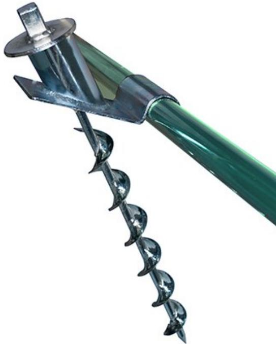
Dispositif d'ancrage système « queue de cochon » pour tube diamètre 101,6 mm. Fabriqué en acier électrozingué. Equipé d'une manivelle et de pattes d'ancrage pour une fixation en biais. Longueur : 42 cm. Jeu de 2.
