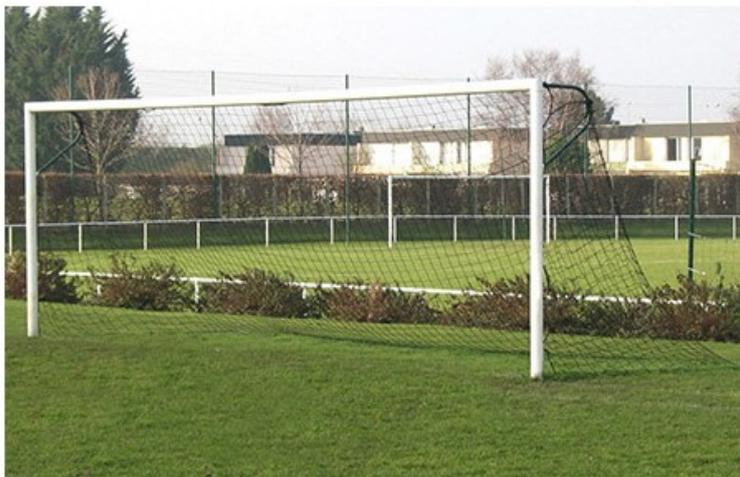
Buts de football à 8 joueurs conforme à la norme NF EN 748. Buts en tube d'acier galvanisé Ø80 mm, finition plastifié blanc. Les retours sont soudés directement sur les montants. Conformément à la norme NF EN 748 la longueur des oreilles est de 80 cm pour un support optimal des filets. Livrés avec crochets PVC pour fixation du filet. Fourreaux en option, nous consulter. Dims (cm) : L600 x H210. Poids 60 kg. Filets en option.
