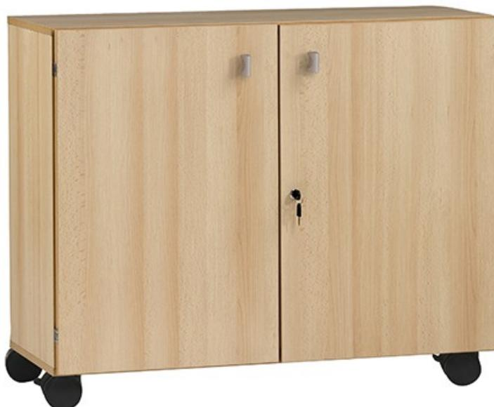
Des meubles mobiles robustes, économiques et très pratiques ! Structure du meuble en mélaminé ép. 19 mm. Coloris hêtre. Assemblage de la structure par tourillons collés. Etagères ép. 12 mm réglables au pas de 32 mm. Portes battantes ouvertures à 270°, serrure 3 points. 2 clés numérotées fournies. Poignée métal. Roulettes doubles galets pivotantes, 2 roues avec freins. Dims (cm) : L120 x P45 x H89.
