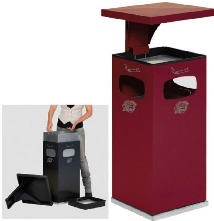
Fabriqués en tôle d'acier galvanisé. Finition peinture poudre époxy anti-UV haute qualité. Nombreux coloris au choix. Systèmes de sécurité à clé. Cendrier amovible de 3 L en partie haute, à remplir de sable. Tamis à mégots galvanisé. Corbeille à 3 ouvertures en partie basse. Seau galvanisée 72 L. Chapeau amovible avec serrure à clé. Base galvanisé à fixer au sol. Dims (cm) : 50 X 50 X H 95,5. Poids : 27 kg.
