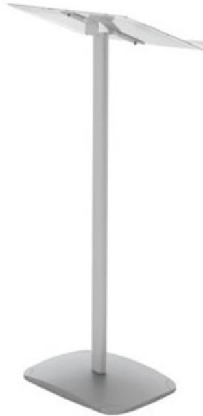
Tablette plexi transparent inclinée 32 x 47 cm, ép. 4 mm. Rebord avant 20 mm pour retenue des documents. Pied alu anodisé naturel sur socle 30 x 42 cm lesté 6 kg. Hauteur 110 cm - Poids 7 kg. Modèle démontable et transportable. La tablette en plexi doit être protégée afin de ne pas être endommagée.
