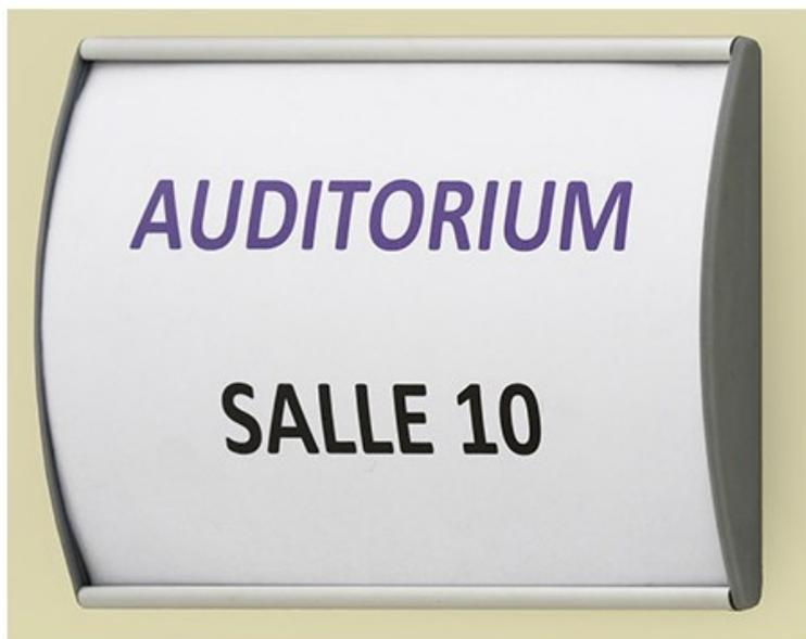
Gamme galbée en aluminium anodisé naturel. Protecteur plexi antireflets, embouts plastiques gris clair aux extrémités. Utilisation sens largeur ou hauteur. Fixation invisible au mur ou sur une porte par 2 vis + 2 chevilles (fournis). Format visuel 150 x 210 mm - Embouts côté 150 mm. 150 x 215 x 20 mm hors tout
