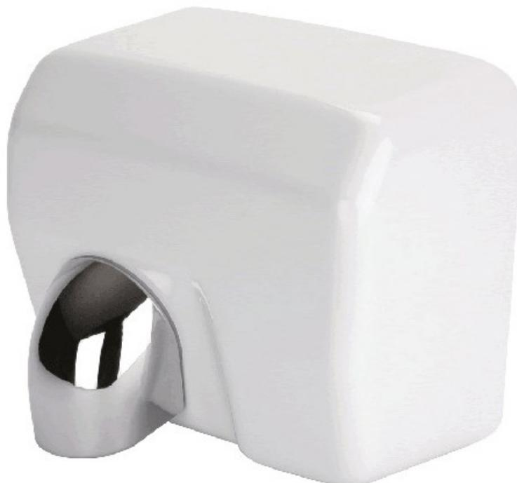
Sèche-main robuste particulièrement efficace et économique. Capot en acier, antivandalisme, épaisseur 2 mm. Finition peinture époxy coloris blanc. Déclenchement automatique par cellule. Buse pour la concentration de l'air. Arrêt automatique en cas de surtension. Temps de séchage 15 secondes. Puissance 2500 W. Niveau sonore : 70 dB. Livré avec son kit de fixation murale. Dims (cm) : L27 X P20 X H24. Poids : 6,25 kg. Garantie 3 ans.
