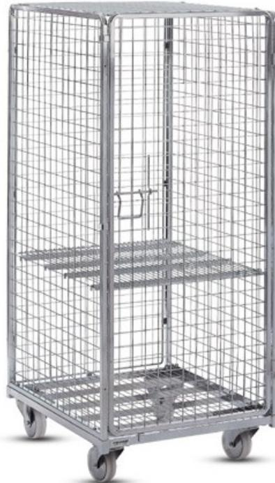
Idéal pour le transport en interne de nombreux éléments en toute sécurité. Construction en tube d'acier carré et fil. Finition zingué brillant. Porte avec arceau permettant le verrouillage par un cadenas si nécessaire (non fourni). 2 roues pivotantes et 2 fixes, diamètre 125 mm, bande de roulement en polyuréthane. Dims (cm) : L 72 X P 81 X H 164.
