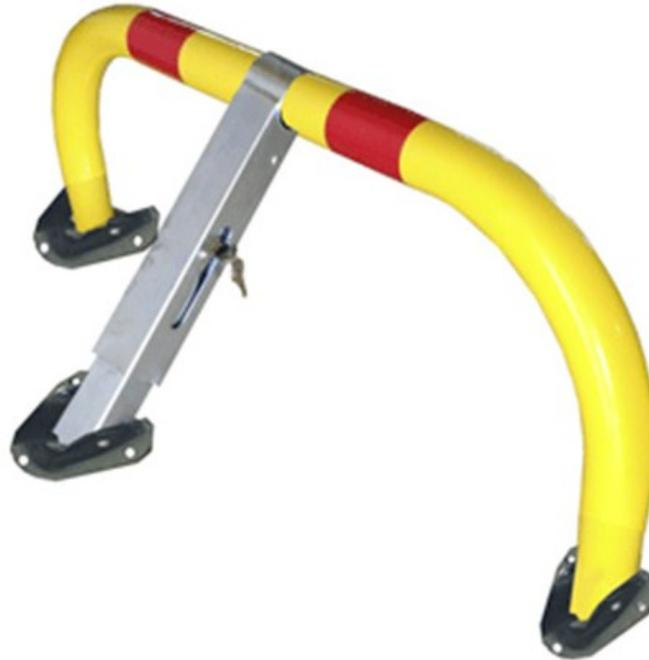
Barrières de parking rabattables avec verrouillage automatique. A clé pompier. Fixation au sol 12 points (fournies). Arceau en tube d'acier de diamètre 55 mm. Barre de soutien en tube d'acier de 60 X 60 mm. Equipées de 2 bagues de frottement en polypro pour faciliter les rotations. Dims (cm) : L 86 X H 45,6. Poids : 10 kg.
