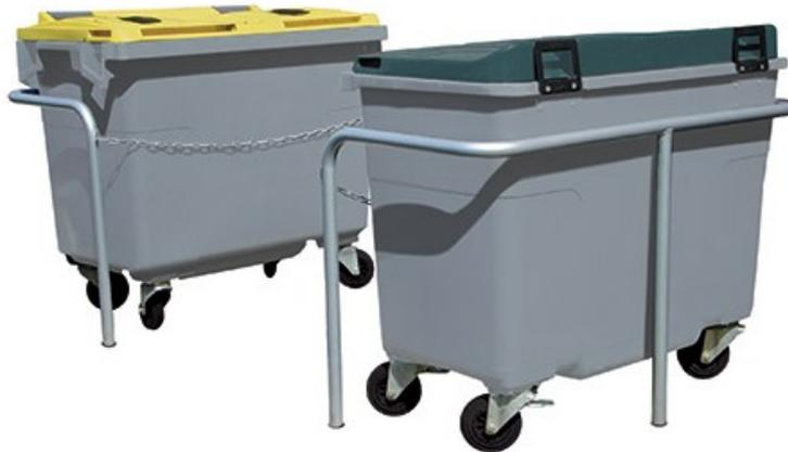
Protège conteneur fixe à chaîne. Fabriquée n tube d'acier diamètre 40 x 2 mm. Finition peinture époxy sur couche zinc antirouille. Plusieurs coloris au choix : aspect alu 310, aspect corten, blanc 9010, gris Basalte 7012, anthracite 7016, noir foncé 9005, jaune Colza 1021, jaune de sécurité 1003, rouge pourpre 3004, marron chocolat 8017, Vert Pin 6028, Vert Mousse 6005, bleu gentiane 5010. Dims (cm) : L 129 X P 75 X H 86,5. A sceller (sur-longueur 20 cm).
