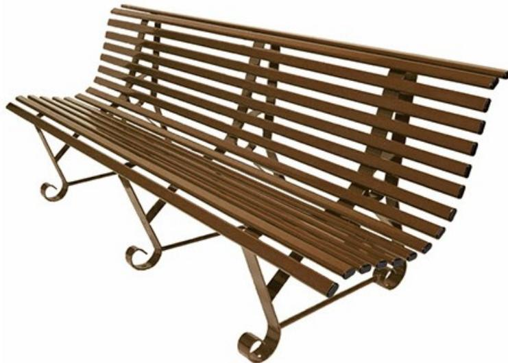
Assise en acier tubes méplats. Piètement en fer plat cintré, 3 pieds. Finition peinture au four coloris vert RAL 6005. Embouts de protection aux extrémités. Longueur 195 cm, Hauteur 74 cm, Assise 38 cm, Largeur 70 cm. Poids 55 kg. En option : accoudoirs, autre RAL, kit de scellement. A poser ou à sceller.
