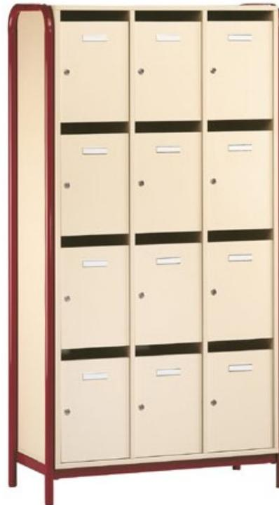
Mobilier livré monté. Structure en mélaminé ép. 19 mm (plusieurs coloris au choix, nous consulter). Chants ABS ép. 2 mm. Portes encastrées avec charnières invisibles à ouverture à 90 degrés et porte étiquette. Fermeture par serrures. Espace disponible au dessus de portes de 40 mm. Piètement métallique (plusieurs coloris au choix, nous consulter). Dims (mm) L X H X P : 900 X 1830 X 450.
