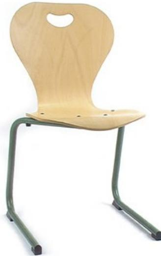
Piètement métallique en tube diam. 25 mm, ép. 2 mm. Plusieurs coloris de piètement au choix, nous consulter. Coque en hêtre multiplis ép. 10 mm. Fixation de la coque sur la structure par rivets acier. Encombrement au sol : L 460 X P 500 mm.
