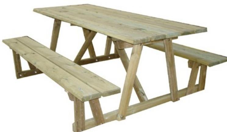
Structure à dégagement latéral, pin du nord rouge Finlande, catégorie 5, gage de stabilité et de haute résistance. Bois traité autoclave classe IV, sans chrome ni arsenic. Visserie inox A2. Assises et plateau composés de lames de section 145 X 32 mm, pieds et renforts 68 X 45 mm. Hauteur d'assise 45 cm. Plateau largeur 80 cm. Livrées pré montées, à sceller. Transformation en version autostable en coupant les sur-longueurs. Longueur : 150 (4 à 6 places).
