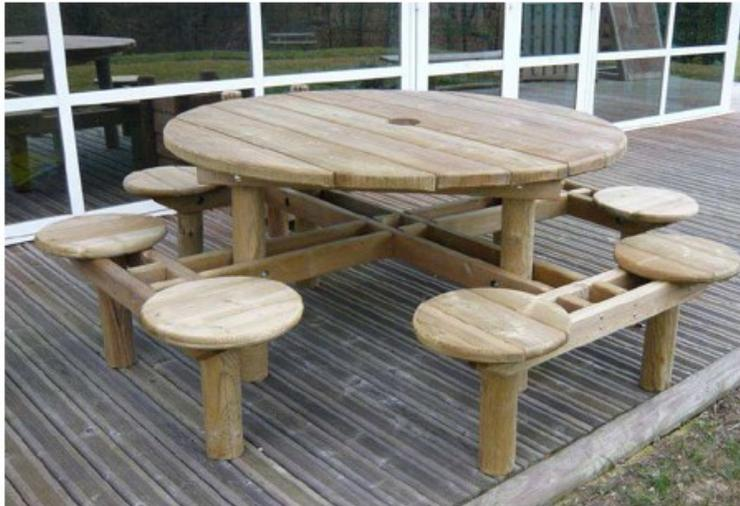
Structure à dégagement latéral, pin du nord rouge Finlande, catégorie 5, gage de stabilité et de haute résistance. Bois traité autoclave classe IV, sans chrome ni arsenic. Visserie inox A2. Lames de plateaux section 190 X 45 mm. Lames d'assises section 130 X 35 mm. Pieds de rondin diamètre 120. Assise diamètre 40 cm. Livrées pré montées.
