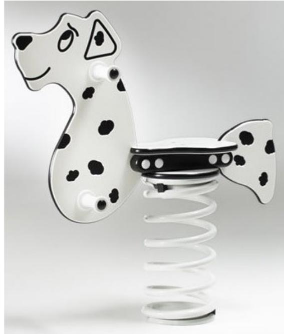
Jeux conformes à la norme En 1176 pour enfants de 2 à 12 ans. Structure en polyéthylène épaisseur 19 mm, teinté dans la masse. Résistance aux UV. Recyclable à 100% Poignées, repose-pieds et cache-écrous en polyéthylène. Ressort 20 mm avec système anti-pincement. Visserie en acier zingué. Version standard avec tabouret d'ancrage à sceller. En option : version sur platine. Zone d'implantation : 7,5 m<sup>2</sup>.
