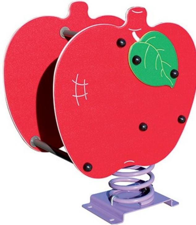
Jeux à ressort pour enfants de 1 à 12 ans, conforme à la norme EN 1176. Hauteur de chute 0,42 m. Espace d'implantation : 269 X 237 cm. Ressort en acier, finition peinture poudre polyester. Forme et assise en polyéthylène, coloré et d'une grande stabilité. Boulonnerie en inox.
