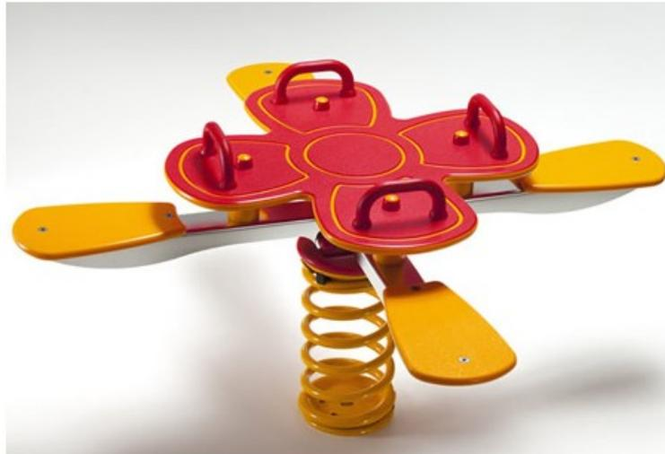
Jeux conformes à la norme En 1176 pour enfants de 2 à 12 ans. Structure en polyéthylène épaisseur 19 mm, teinté dans la masse. Résistance aux UV. Recyclable à 100% Poignées, repose-pieds et cache-écrous en polyéthylène. Ressort 20 mm avec système anti-pincement. Visserie en acier zingué. Version standard avec tabouret d'ancrage à sceller. En option : version sur platine. Zone d'implantation : 10 m<sup>2</sup>.
