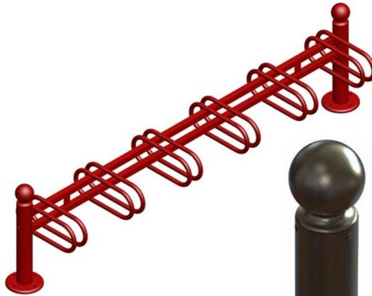
Support vélo 6 places, thermolaqué, coloris au choix nous consulter. Poteaux en tube acier de diamètre 76 mm. Traverse en tube acier 30x30. Arceaux en tube acier de diamètre 22 mm. Modèle à sceller. Dim (cm) : L 225.5 x H 56.2, hors sol 105. Poids 24.5 kg.
