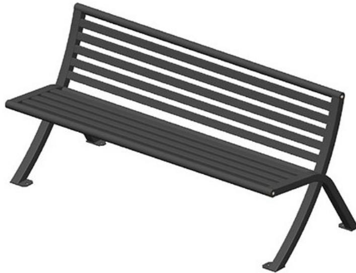
Pieds en tube acier 50x40, tube horizontaux acier diamètre 42 mm, thermolaqués gris anthracite ral 7016. Lames en acier ep 18 mm. Livré en kit à monter. Dim (cm) : L 175.2 x P 58.6 x H 74.1, Hauteur assise 43.3. Poids 46 kg.
