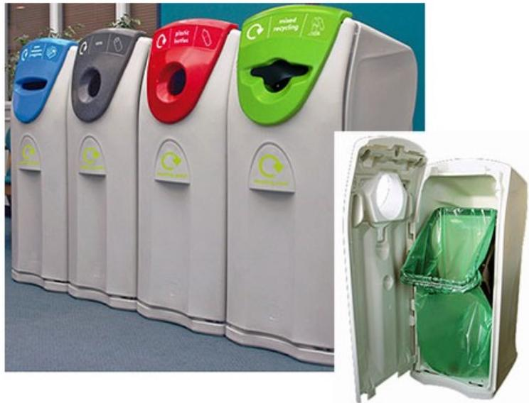
Collecteur moderne pour espaces collectifs fabriquées en MDPE. Porte sur la face avant pour un accès facile au porte sac intérieur de 140 L. Fixation au sol ou par lestage intégré. Ouverture avec fente d'insertion coloris bleu. Dims (cm) : L 55 X P 61,5 X H 122.
